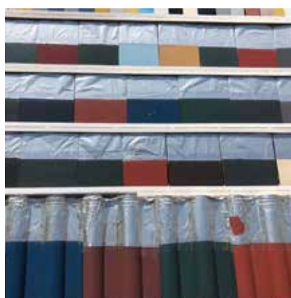
THỬ NGHIỆM CHẤT LƯỢNG NGÓI TRONG THỰC TẾ
